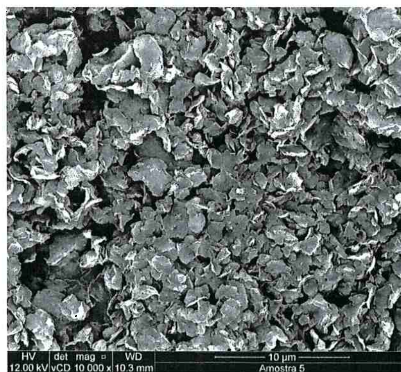
Figura 43: Argila Organofilizada. Aumento de 10.000X.
