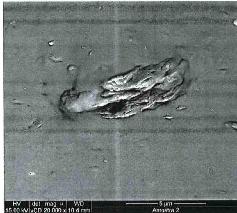
Figura 32: NR + Arg. Organofilizada (A) com precipitado de Argila. Aumento de 20000x.
