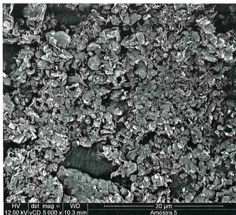
Figura 42: Argila Organofilizada. Aumento de 5000X.
