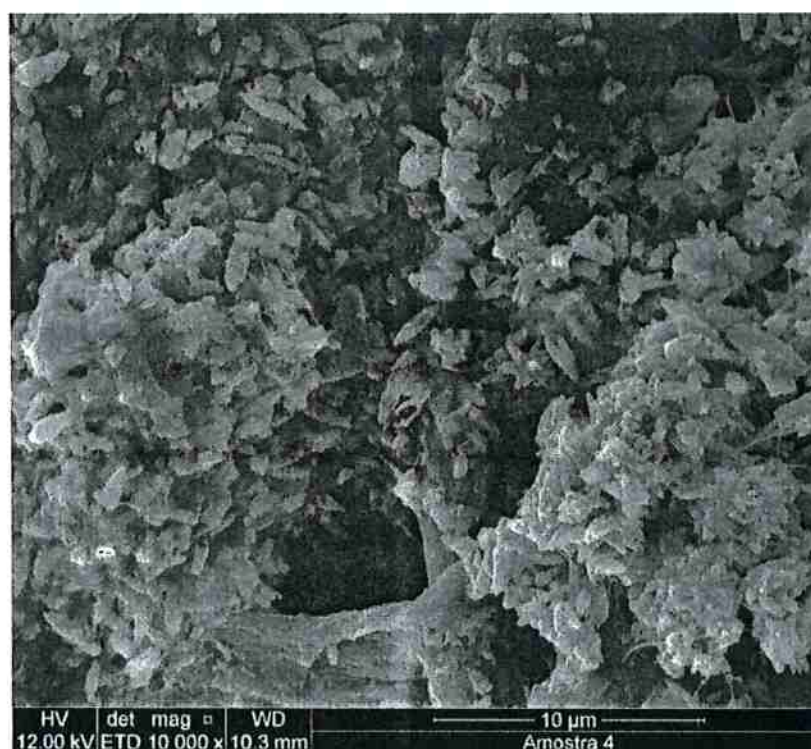
Figura 41: Celulose tipo 1. Precipitados de CaO. Aumento de 10.000X.
