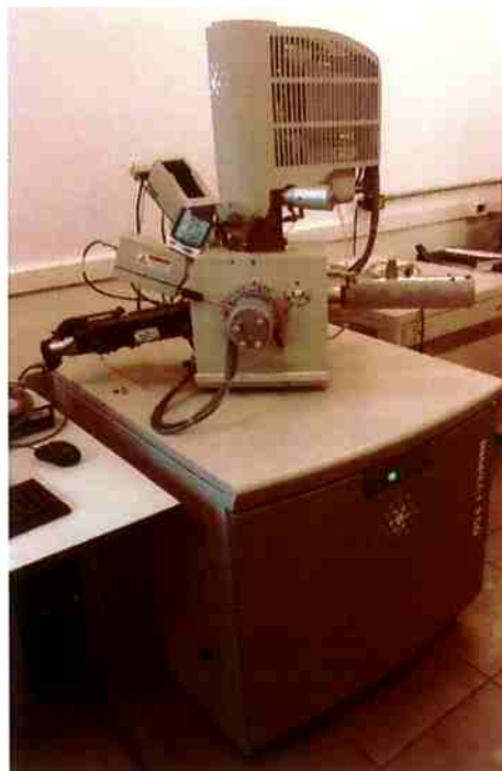
Figura 13: MEV modelo FEI-INSPECT S50, utilizado para realizar as análises microestruturais.
