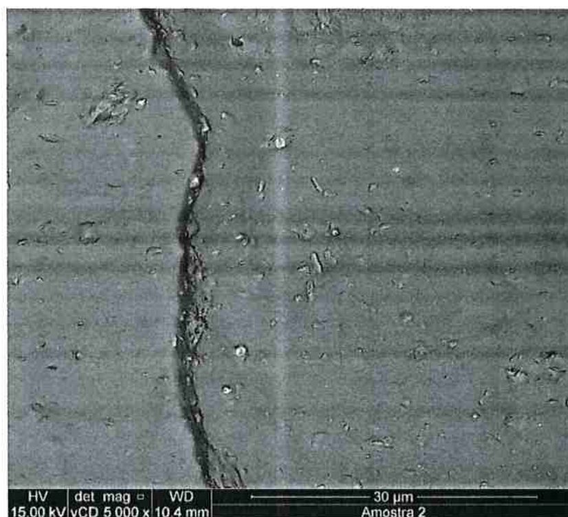
Figura 30: NR + Arg. Organofilizada (A). Aumento de 5000x.
